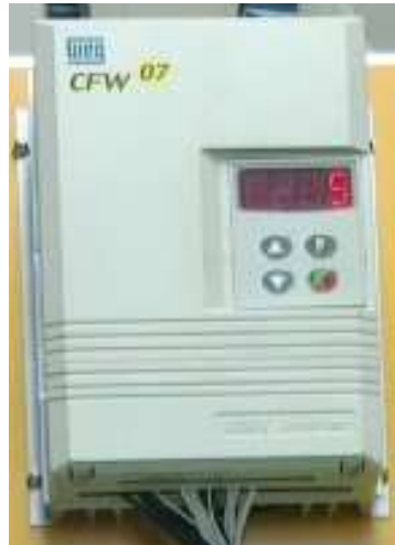
Figura 1 – Inversor de Frequência WEG CFW-07
